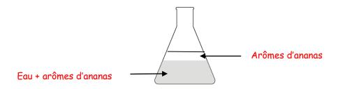
La densité de l'huile essentielle d'ananas est plus faible que celle de l'eau : L'huile essentielle surnage. L'huile essentielle est en partie miscible dans l'eau donc la phase inferieure contient un mélange eau huile essentielle.
